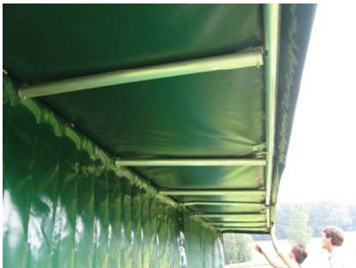
Vordach-Streben einlegen bei den Modellen mit Vordach
